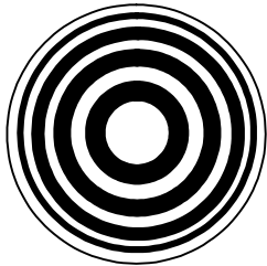
Рис. 5.1. Вид зонной пластинки Френеля
