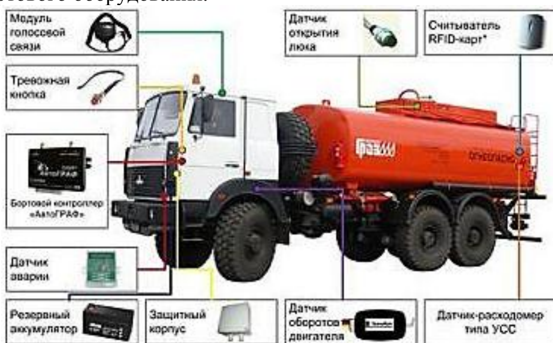
Рисунок 3.11 – Вариант установки комплекта бортового оборудования на бензовозе
